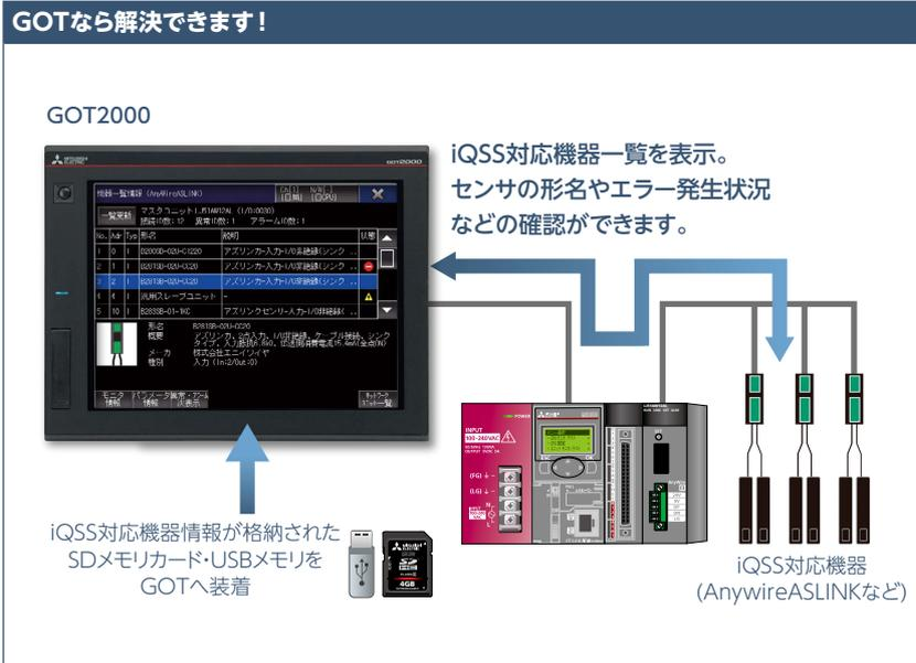
iQSS対応機器(AnywireASLINKなど)の状態・パラメータ情報をGOTで確認できるため、パソコンレスで作業ができます。
