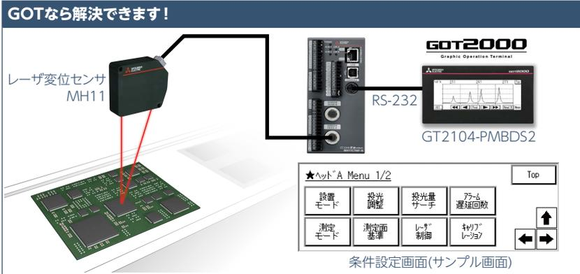
GOTで受光量波形表示、測定値表示、条件設定ができ、パソコンレスで作業ができます。
