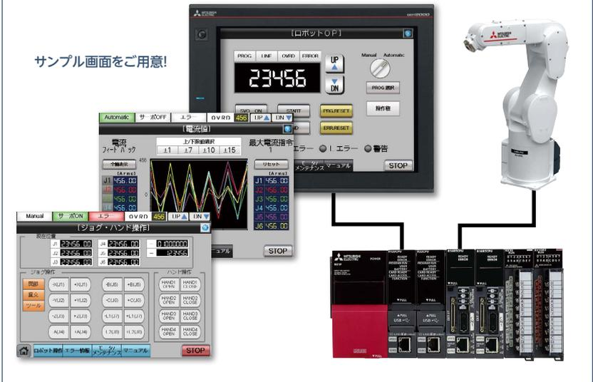
GOTからロボットの操作や状態モニタができます。GOTからロボットの起動・停止、エラー情報のモニタなどを容易にできます。
