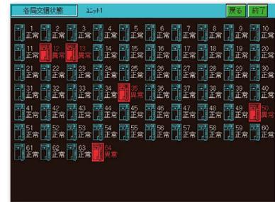
CC-Link IEコントローラネットワーク、CC-Link IEフィールドネットワーク、MELSECNET/H、MELSECNET/10のネットワーク状態をモニタし、GOTに表示できます。
